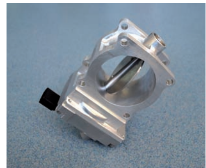
7 Anbau des BLDC-Motors an einer Bremsklappe
