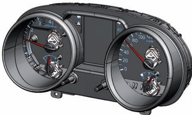
① Kombiinstrument mit vier „Slimline“ Schrittmotoren
