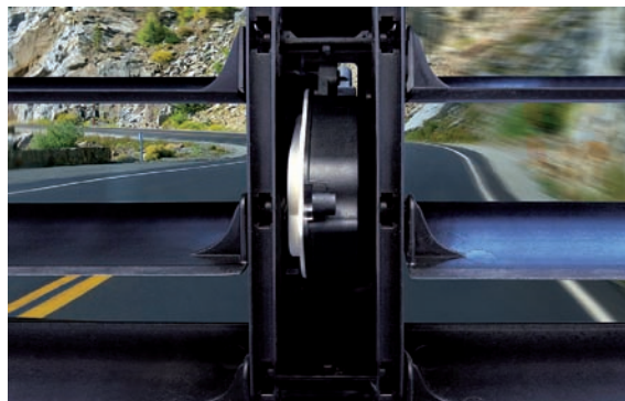
1 Der Aktuator positioniert die Lamellen des Kühlluftklappensystems montiert in der Kühlerverkleidung
